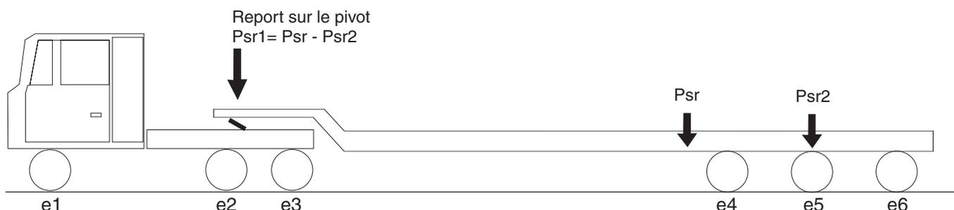
La masse  $P_{sr}$  de la semi-remorque à vide se répartit sur les essieux arrière de la semi-remorque ( $P_{sr2}$ ) et sur le pivot d'attelage ( $P_{sr1}$ ) correspondant à la sellette du véhicule tracteur
